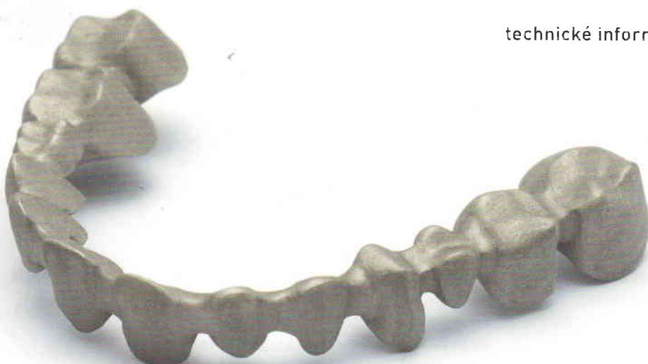
Laserem sintrováný CoCr je svými vlastnostmi naprosto rovnocenný frézovanému kovu a použitá výrobní technologie zaručuje nesrovnatelně lepší vlastnosti a přesnost ve srovnání s kovem odlévaným ručně. Technologie 3D tisku z CoCr prášku umožňuje zhotovit i tvary, které jsou frézováním technicky nedosažitelné. Obecně je technologie laserového sintrování díky své vysoké efektivitě nejlevnější a nejvýhodnější metodou zhotovení CAD/CAM kovové konstrukce.
